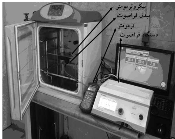
شکل ۲ نحوه به‌کارگیری میکروترموتر برای اندازه‌گیری دمای محیط کشت و دمای محیط انکوباتور
