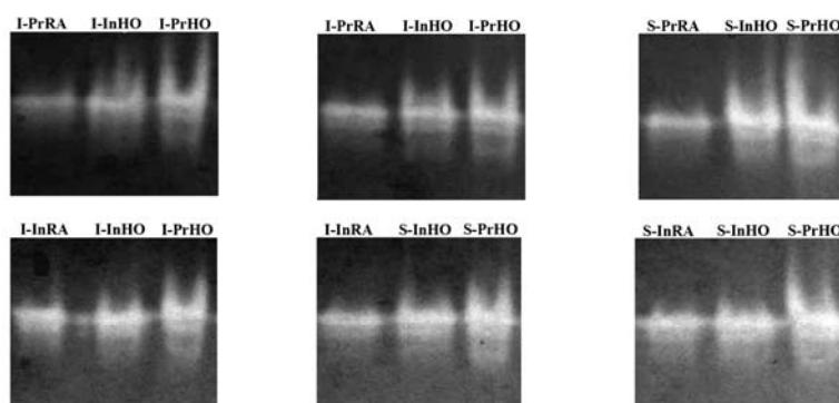
شکل ۱ رنگآمیزی PAGE فعالیت آنزیم SOD در گروه‌های مختلف آزمایش و کنترل. در این شکل S-InHO، S-InRA، S-PrHO، S-PrRA به ترتیب نشانگر گروه‌های شم نورموکسی نورموباریک پیوسته، هیپرکسی نورموباریک پیوسته، نورموکسی نورموباریک متناوب و هیپرکسی نورموباریک متناوب و HO، I-InRA، I-PrHO، I-PrRA، I-InHO به ترتیب نشانگر گروه‌های دست‌نخورده هیپرکسی نورموباریک متناوب، نورموکسی نورموباریک پیوسته، هیپرکسی نورموباریک پیوسته، نورموکسی نورموباریک متناوب هستند.
