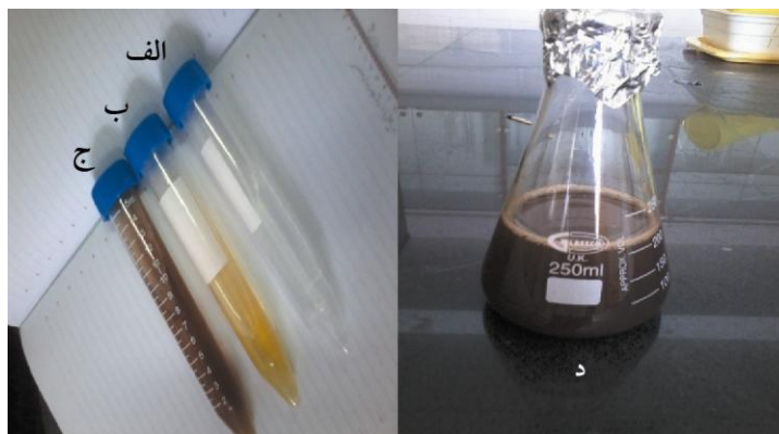
شکل ۲ ساخت نانوذرات نقره از عصاره قارچ دنبلان؛ (الف) محلول نیترات نقره، (ب) عصاره، (ج) ده دقیقه بعد از مخلوط شدن عصاره با نیترات نقره، (د) ۲۴ ساعت بعد از تکان دادن
