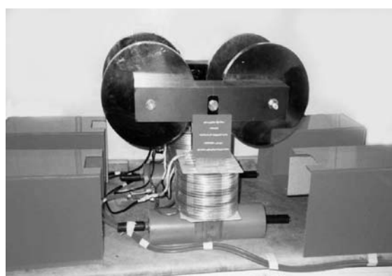
شکل ۲ دستگاه مولد میدان مغناطیسی ایستا
