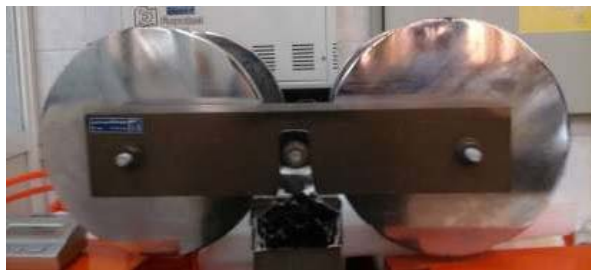
شکل ۱- دستگاه مولد میدان مغناطیسی ایستا
