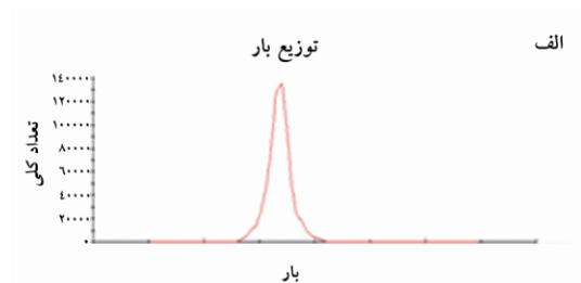
شکل ۳ تصویر حاصل از اندازه‌گیری اندازه، بار (الف) و پراکنش چندگانه (ب) نانوذره پلی‌پورتان بارگیری شده با کورکومین با استفاده از دستگاه پراکنش نوری دینامیک
