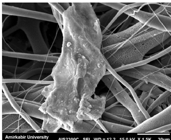
شکل ۲ تصویر SEM از چسبندگی سلول مزانشیمی ژله وارتون بر داربست PLA الکتروریسی شده در غلظت ۱۵ درصد حجمی/وزنی
