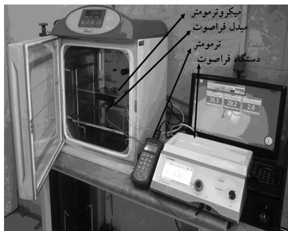
شکل ۲ نحوه به‌کارگیری میکروترموتر برای اندازه‌گیری دمای محیط کشت و دمای محیط انکوباتور
